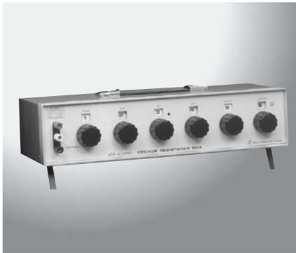
6ダイヤル式ディケード標準抵抗器は、精密抵抗器部、ロータリースイッチ部、出力端子部、二重シールド部に特長がある、6 $\frac{1}{2}$ 桁の任意の抵抗値を設定可能な高精度標準抵抗器です。
